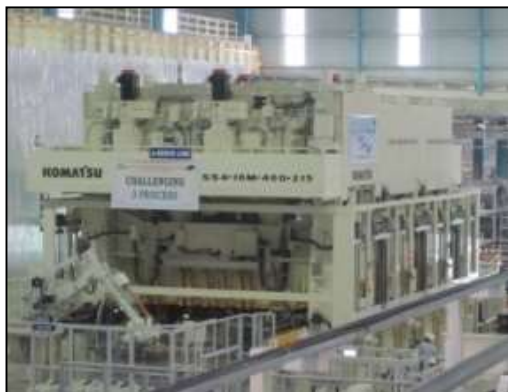
Energy efficient Servo Press (Energy Saving : 40%)
